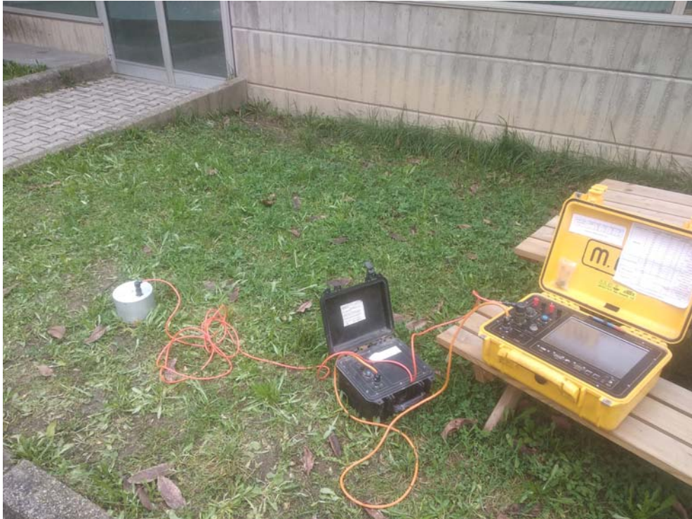
Fig. 8.1 – Attrezzatura utilizzata per misure HVSR
