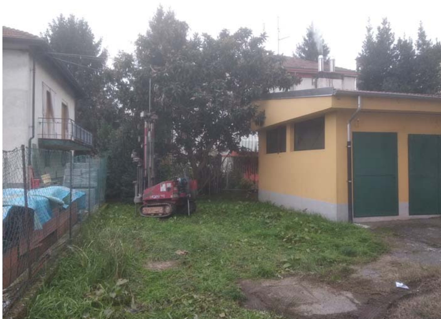
Foto 1 e 3: Esecuzione prove penetrometriche Din1 e Din3.
