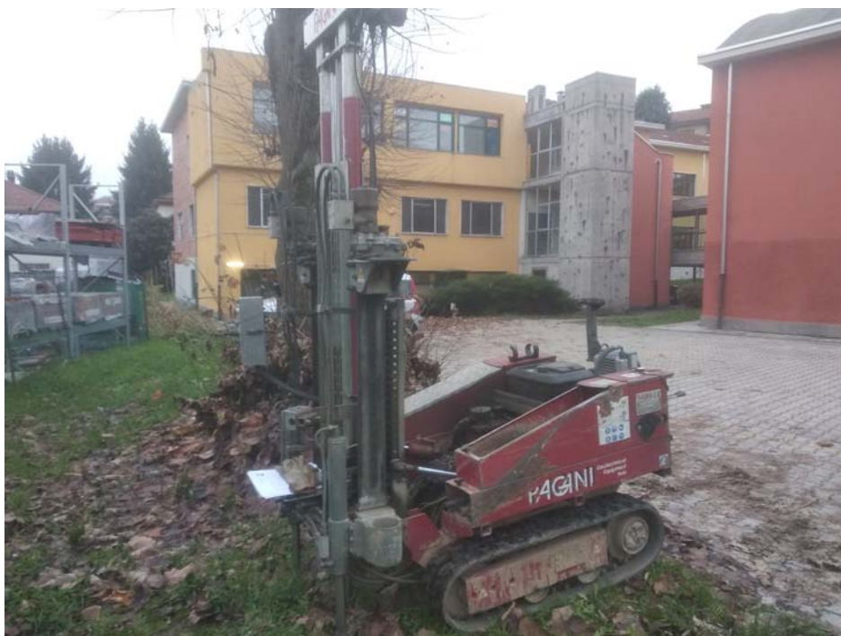
Foto 1 e 3: Esecuzione prove penetrometriche Din1 e Din3.
