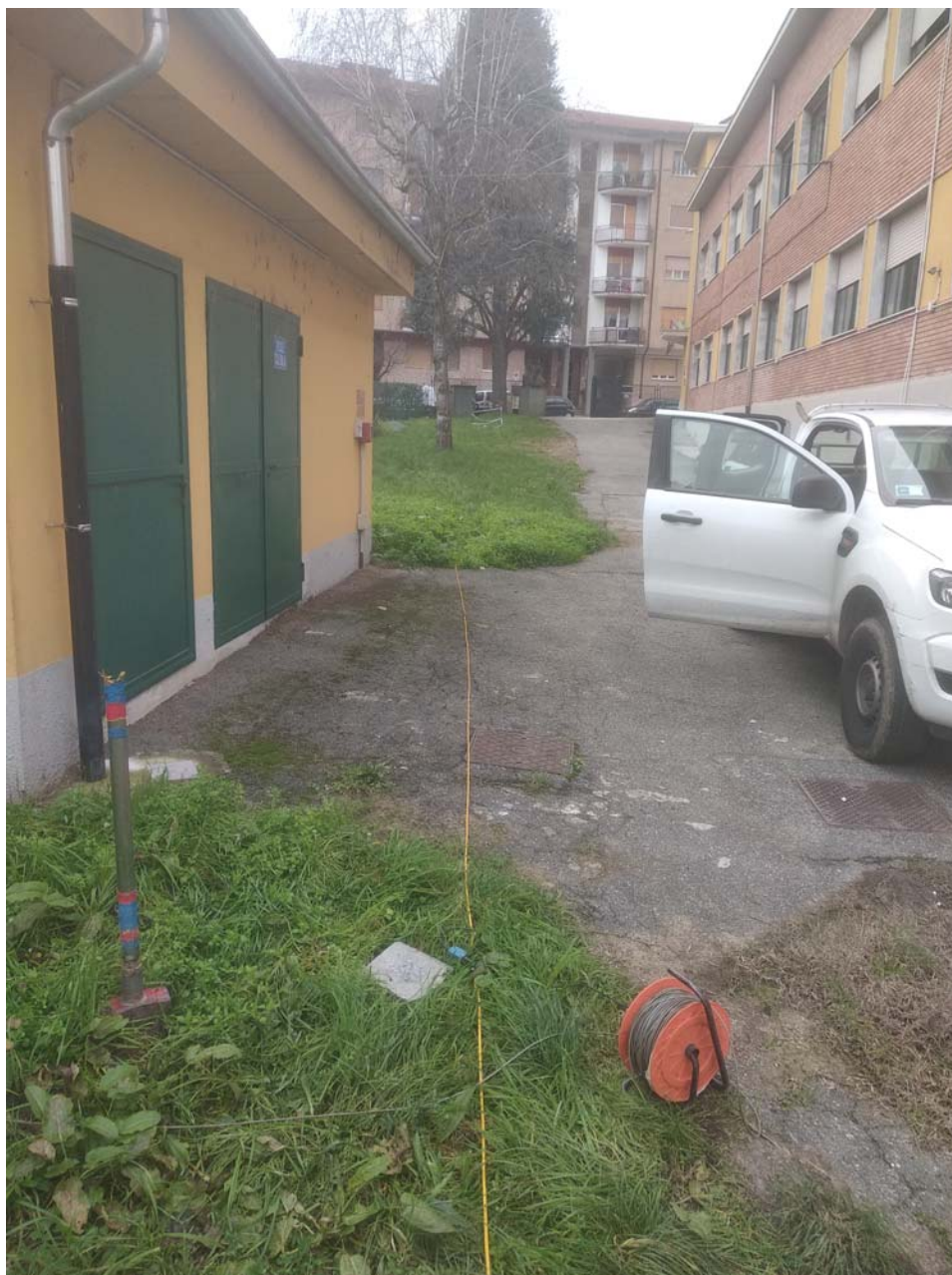
Foto 3: Esecuzione stendimento MASW
